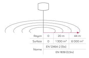
Comprendre le schéma : dans un rayon d'action de 44 m, soit une surface de 6000 m², nous garantissons un éclairage conforme à la norme EN1838.
